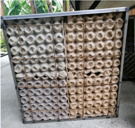
Figura 1. Probeta: módulo de 0,60 x 0,60 listo para uso de mortero de acabado (2020). Fuente: Liliana Hernández.
