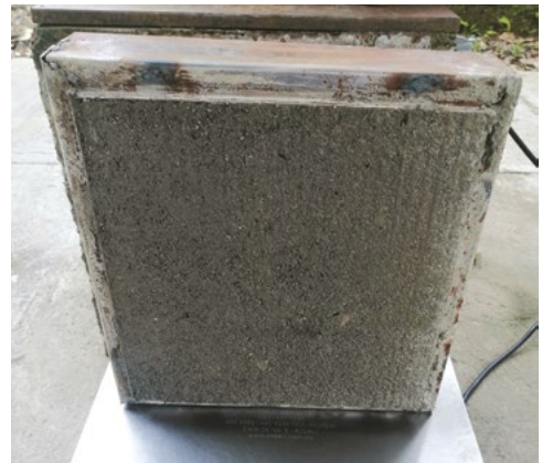
Figura 4. Probeta: acabado final del módulo de la probeta de 0,30 x 0,30 (2020). Fuente: Liliana Hernández.
