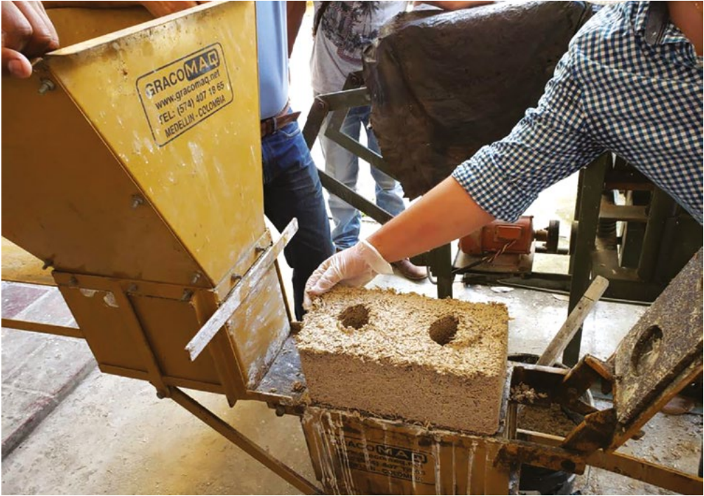
Figura 3. Bloque comprimido de cal-cáñamo fabricado con la máquina Cinva Ram. Fotografía Ricardo Hincapié A.
