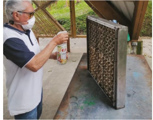
Figura 2. Probeta: saturación del cartón de huevo para adherencia del mortero (2020). Fuente: Liliana Hernández.
