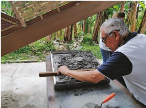
Figura 3. Probeta: instalación de mortero en el módulo tendimuro (2020). Fuente: Liliana Hernández.
