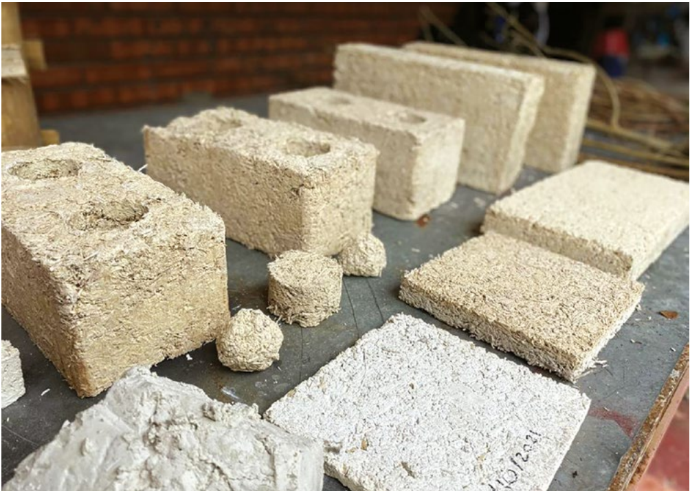
Figura 4. Ejemplo de posibles ecomateriales a producir basados en el compuesto cal-cáñamo. Fotografía Ricardo Hincapié A.
