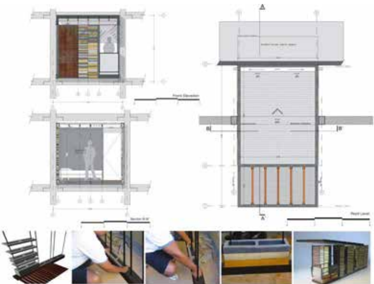
// Corte transversal y planta cubierta del módulo
