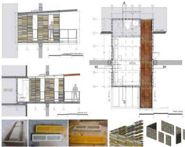
// Corte longitudinal y planta módulo
